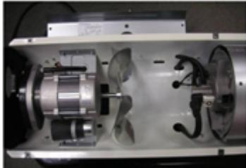
Все соединения выполнены аккуратно. К датчикам перегрева и фотоэлементу обеспечен легкий доступ.
