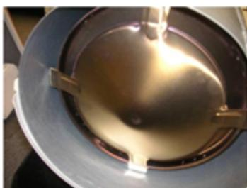
Пламегаситель выполнен из специального жаропрочного сплава японского производства. Этим обеспечивается его долговечность (сварка не прогорает, пламегаситель не отваливается).
