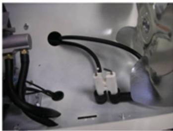
Свеча поджога выполнена в виде двух разрядных стержней в едином керамическом корпусе. Такой тип намного долговечнее, чем свечи «автомобильного» типа. Система воспламенения работает по тому же принципу что используется в пушках MASTER серии CED, т.е. отсутствует свеча накала, свеча дает искровой разряд через определенные промежутки времени для обеспечения стабильности горения.
