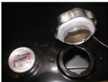
Топливный бак оснащен простым элегантным и информативным указателем уровня топлива. Крышка топливного бака закрывается на пол-оборота (не на резьбе, которую в мороз не открутить).
