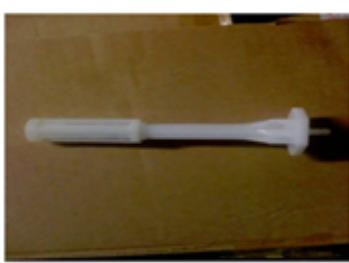
Топливный фильтр находится непосредственно в топливном баке. Во многих нагревателях других производителей используется топливный фильтр накопительного типа. Когда такой фильтр забивается грязью, топливо перестает поступать, фильтр можно только заменить. Данный же фильтр погружен в топливо и происходит как бы небольшое самоочищение его обтекающим топливом. Фильтр не является накопительным, легко разбирается для промывки. Топливные фильтры нуждаются в замене крайне редко.
