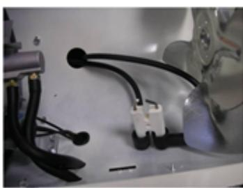
Свеча поджога выполнена в виде двух разрядных стержней в едином керамическом корпусе. Такой тип намного долговечнее, чем свечи «автомобильного» типа. Система воспламенения работает по тому же принципу что используется в пушках MASTER серии CED, т.е. отсутствует свеча накала, свеча дает искровой разряд через определенные промежутки времени для обеспечения стабильности горения.
